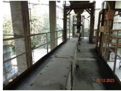
รูปที่ 2-31 ระบบสายพานแบบปิดลำเลียงฝุ่นจาก Dust Precipitation กลับเข้าสู่กระบวนการผลิต
