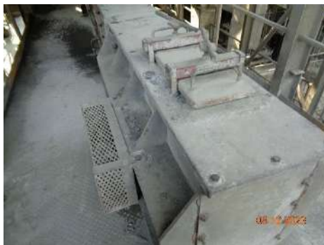
รูปที่ 2-30 ระบบสายพานแบบปิดเพื่อลำเลียงฝุ่นจาก P/H Boiler กลับเข้าสู่กระบวนการผลิต
