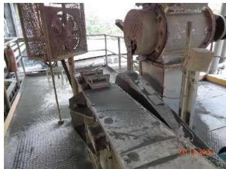
รูปที่ 2-30 ระบบสายพานแบบปิดเพื่อลำเลียงฝุ่นจาก P/H Boiler กลับเข้าสู่กระบวนการผลิต
