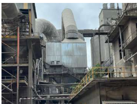
รูปที่ 2-3 Dust Precipitation โรงงาน 2 (สายการผลิตที่ 3)
