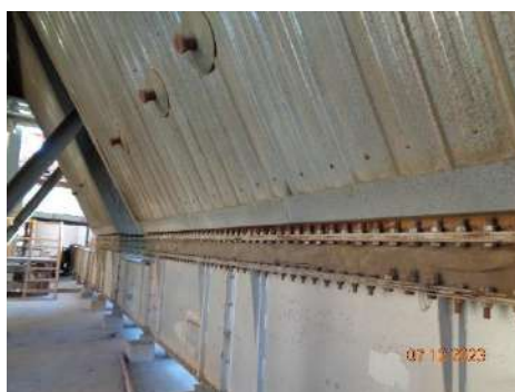
รูปที่ 2-5 ระบบสายพานแบบปิดเพื่อลำเลียงฝุ่นจาก P/H Boiler กลับเข้าสู่กระบวนการผลิต
