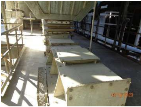
รูปที่ 2-6 ระบบสายพานแบบปิดลำเลียงฝุ่นจาก Dust Precipitation กลับเข้าสู่กระบวนการผลิต
