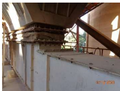
รูปที่ 2-5 ระบบสายพานแบบปิดเพื่อลำเลียงฝุ่นจาก P/H Boiler กลับเข้าสู่กระบวนการผลิต
