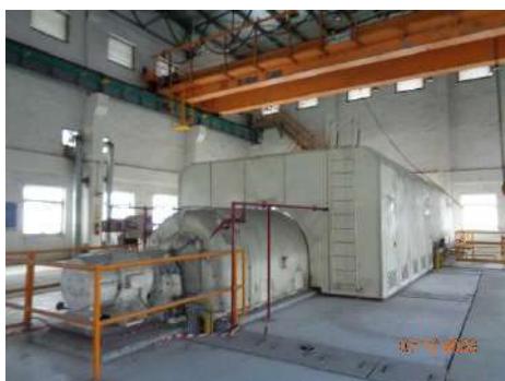
รูปที่ 2-18 อาคารปิดคลุมเครื่องจักรที่มีเสียงดังภายในพื้นที่โรงงาน 2 (สายการผลิตที่ 3)
