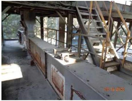
รูปที่ 2-31 ระบบสายพานแบบปิดลำเลียงฝุ่นจาก Dust Precipitation กลับเข้าสู่กระบวนการผลิต
